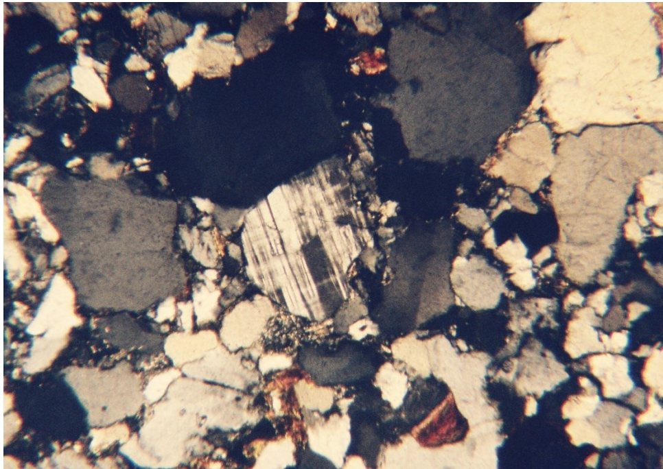
Pískovec křemenný, jemnozrnný, silicifikovaný, vzorek K-I, balustráda, zvětšení 32x, nikoly X, přítomnost živců – mikroklin ve struktuře křemenných klastů
